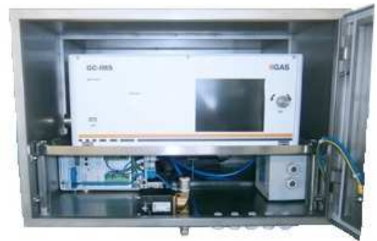
图 6: 为了监测化工厂中的TIC，GC-IMS 仪器嵌入到加压外壳系统。加压外壳系统确保安全等级Ex II 2 G Ex px II T4 (德国防爆条例)。
