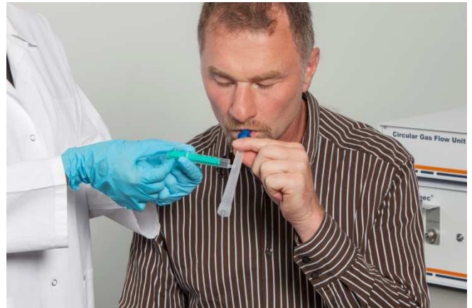
图1：手动取样选择 将呼出气体取样到储存器（注射器）中，然后手动注入仪器（图2）。
