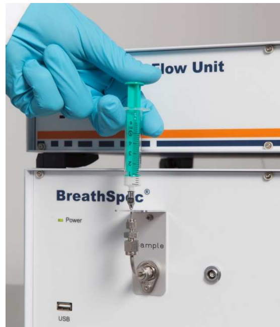
图2： 将样品注入仪器的鲁尔(Luer) 接口。
