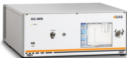
Abb. 1: GC-IMS VON G.A.S. für die online vor-Ort Analyse von Permanentgasen und VOCs.
